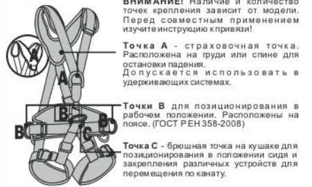
Рис. 3. Расположение и назначение крепежных точек на привязях
