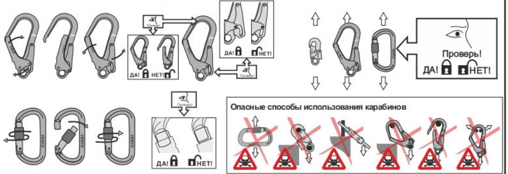
Рис. 6. Способы крепления стропов к анкерным устройствам
