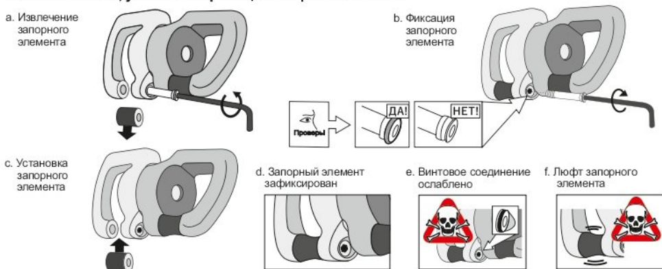
Рис. 4. Извлечение, установка и фиксация запорного элемента
